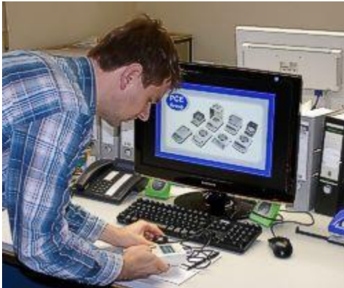
Der Lichtstärkemesser PCE-L 100 bei einer Arbeitsplatzbelichtungsmessung
