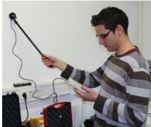
Lichtstärkemesser PCE-L 100 mit Armverlängerung (im Lieferumfang)
