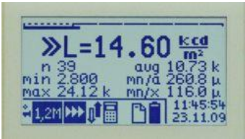
Lichtstärkemesser - Displayanzeige Leuchtdichte inkl. Anzeige der Statistik
